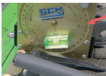
Winkelmesser zur Schneidwerkseinstellung 12-14 Grad
